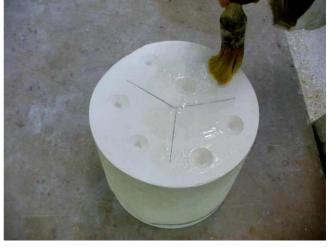
6/ Après la prise, on creuse des clés et on savonne l'ensemble pour couler un fond.
