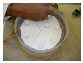
7/ Ce fond n'a qu'une fonction de centreur pour les 3 parties du moule qui en sont dépourvues. Dans ce cas, l'étanchéité peut être faite à l'intérieur du coffrage.
