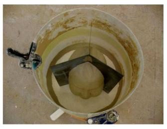
4/ Après coffrage, on constate que le plâtre pourra facilement circuler sur le pourtour sans trop de risque de déformation des radios.
