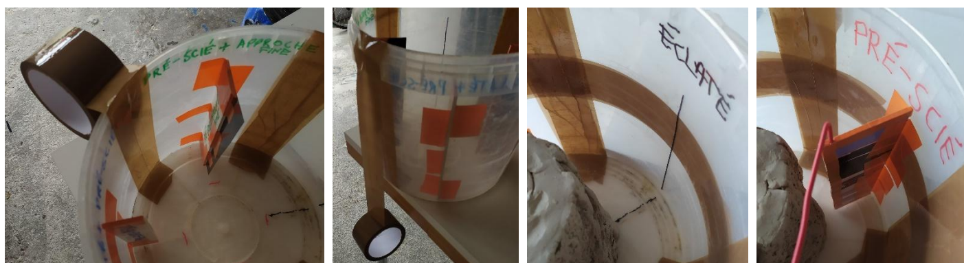
Étanchéité du seau intérieure et extérieure + ceinture centrage du modèle Fixer le pré-scié L'ÉTANCHÉITÉ DES VERTICALES SE FAIT AVANT LA CEINTURE À L'ADHÉSIF (MARRON, FIN ET PAS CHER). PENSER À PLACER LES PRÉ-SCIÉS ENTRE LES ZONES D'ÉTANCHÉITÉ VERTICALES DU SEAU. LE FIL ÉLECTRIQUE (ROUGE) PERMET DE SOLIDARISER ET MAINTENIR DES ÉLÉMENTS ENTRE EUX OU TOUTE AUTRE FAÇON POUR GARANTIR LA BONNE TENUE D'UN PRÉ-SCIÉ (OU PRÉ-ÉCLATÉ) DANS SON AXE.
