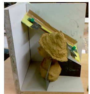
Ph. 9, Synt. Tech. sept. 10, p. 8/9 (à venir) Moule combiné en raccourci (3 parties en bas) + Présciés + tenons (en plan incliné).
