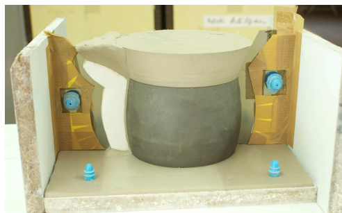
Ph. 8, MâJ déc.2010 (à venir) Moule en raccourci avec Présciés pour rigidifier les radios.
