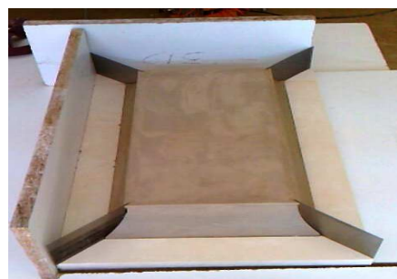
Ph.18 Le maintien des 4 côtés sera assuré par un fond.
