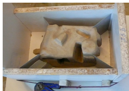
Ph.19 Le maintien des 4 côtés sera assuré par un fond + bride.
