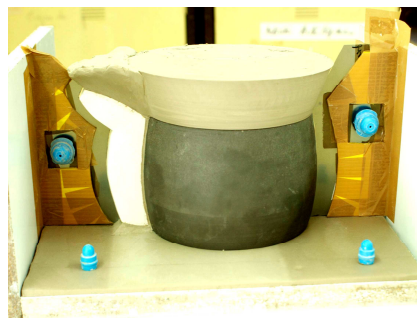
Ph.8 Avec du carton ondulé en plastique ou du carton plume, et fixé sur le coffrage.
