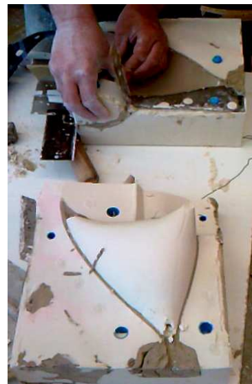
Ph.22 Ouverture du moule et élimination des surépaisseurs des radios avant de faire le fond en bouchon.
