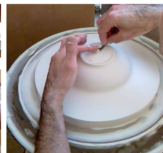
Ph.36 Retouche du centre + ABRASIF À L'EAU si besoin.
