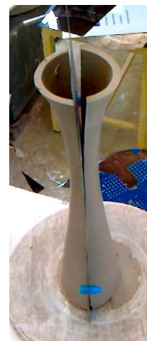
Ph.16 Modèle creux tourné et coupé pour le rétrécir en lentille.
