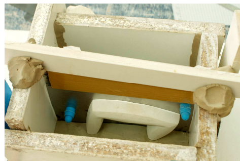
Ph.17 Avec un élément rigide posé sur le coffrage et solidarisé au raccourci avec de l'adhésif.
