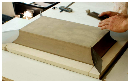
Ph.14 Modèle plein traîné en terre crue + incisions sur les arrêtes des 4 angles dans l'axe des diagonales.
