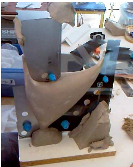
Ph.7 Trous répartis dans les zones libres pour faciliter la répartition du plâtre.
