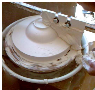
Ph.35 Dernier passage + finition à l'eau si besoin.
