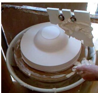
Ph.33 Main gauche prête à récupérer le plâtre.
