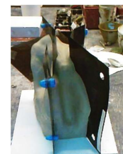
Ou encore, en installant des guides sur le coffrage pour garantir les verticales.
