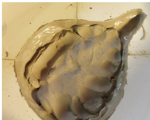
Terre collante au contact du moule et remplissage à la terre molle.
