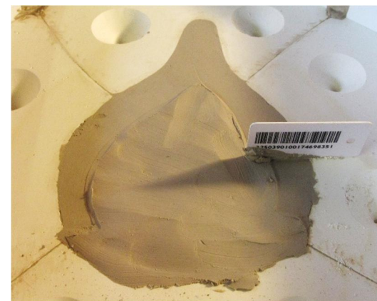
Arraser proprement avec une raclette en plastique semi-rigide.
