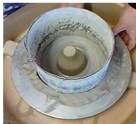
Éviter de déformer le modèle en coffrant sur le tour
